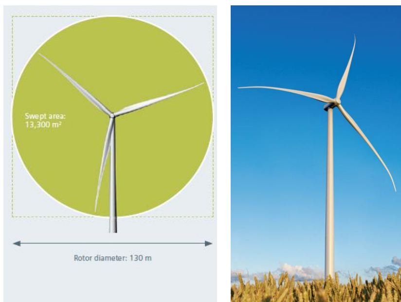
Figur 3-3. Dimensioner for Siemens SWT-130 møllen (Simens, 2014). Navnhøjden for møllerne ved Thorup-Sletten vil være 85 m for møller med en rotordiameter på 130 m.
