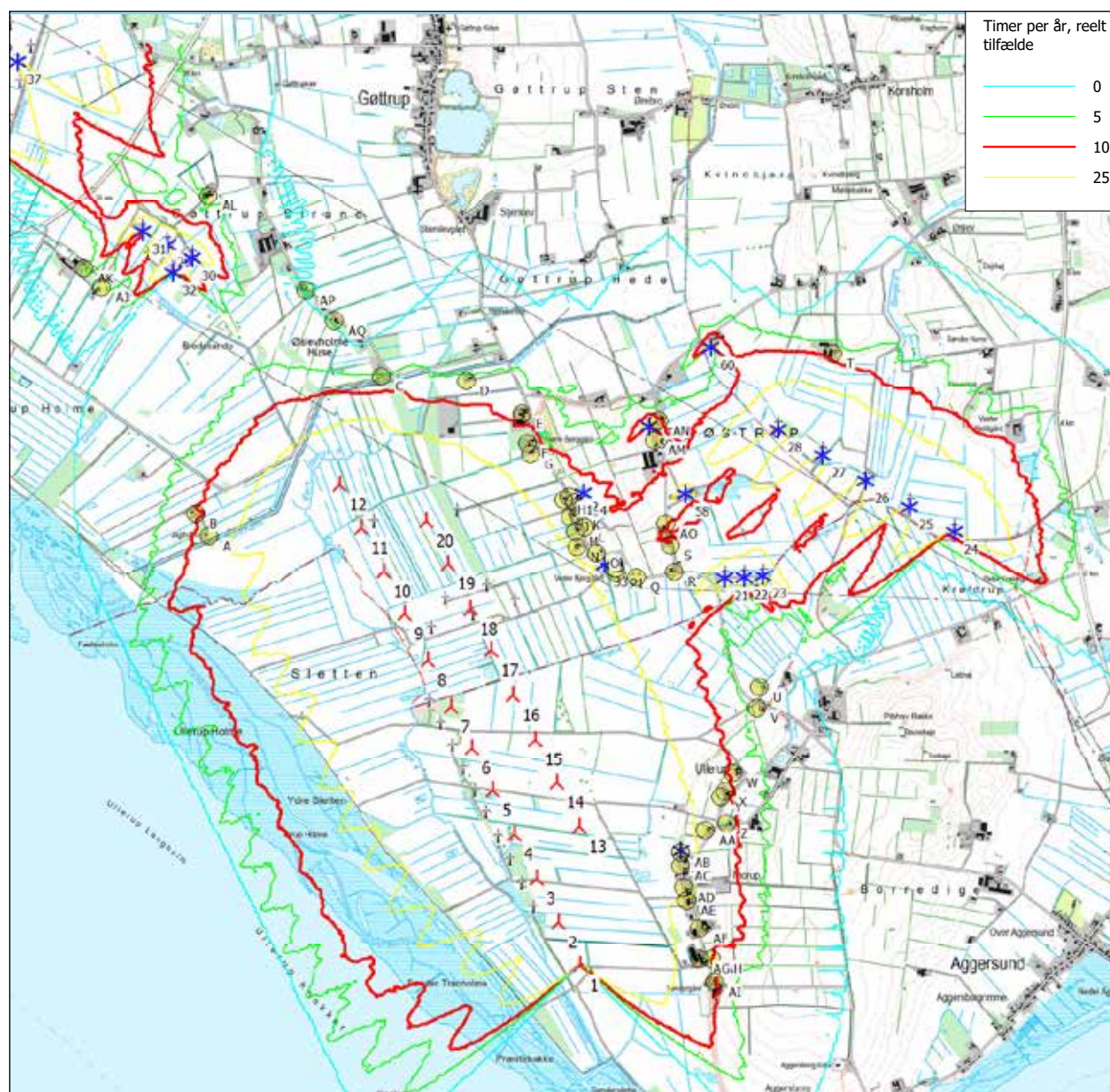
Figur 4.25. Kort over udbredelse af beregnet skyggekast. Linjerne viser skyggekast i timer pr. år beregnet som reel værdi. Rød angiver grænseværdien på 10 timer pr. år.
